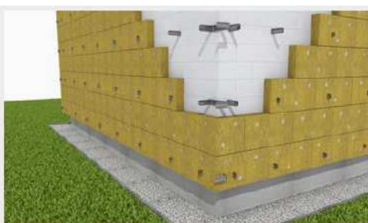
Ułożenie i zakotwienie wełny do ściany.
