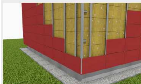
Zamocowanie płyt elewacyjnych.
