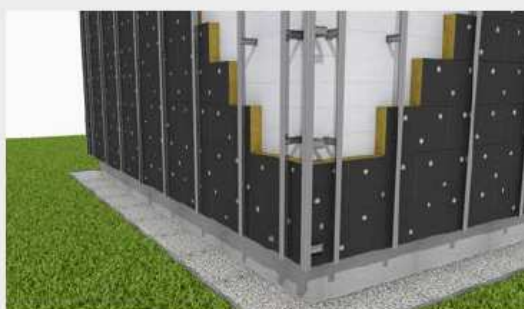
Mocowanie profili podkonstrukcji do konsol.
